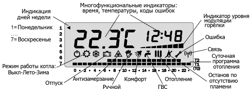
Рисунок 42. Описание ЖКИ-индикатора и отображаемых символов и пиктограмм
